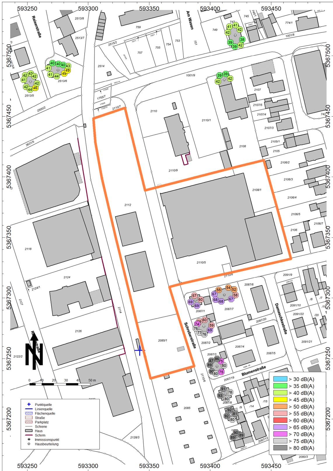
Abbildung 23: Pfeifsignale der Bahn, ausgelöst 10 m vor der Pfeiftafel, Maximalpegel  $L_{A,max}$  entlang der Fassaden von Wohngebäuden außerhalb des Plangebiets im Prognose Nullfall. Höchster über alle Geschosse je Fassadenabschnitt.
