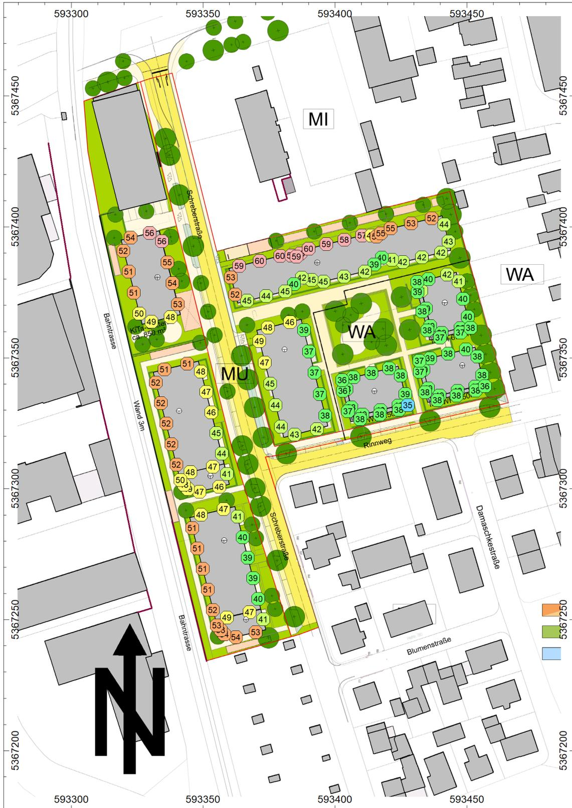
Abbildung 14: Lageplan mit Darstellung der höchsten Beurteilungspegel über alle Geschosse entlang der Fassaden der im Plangebiet vorgesehen Bebauung am Tag
