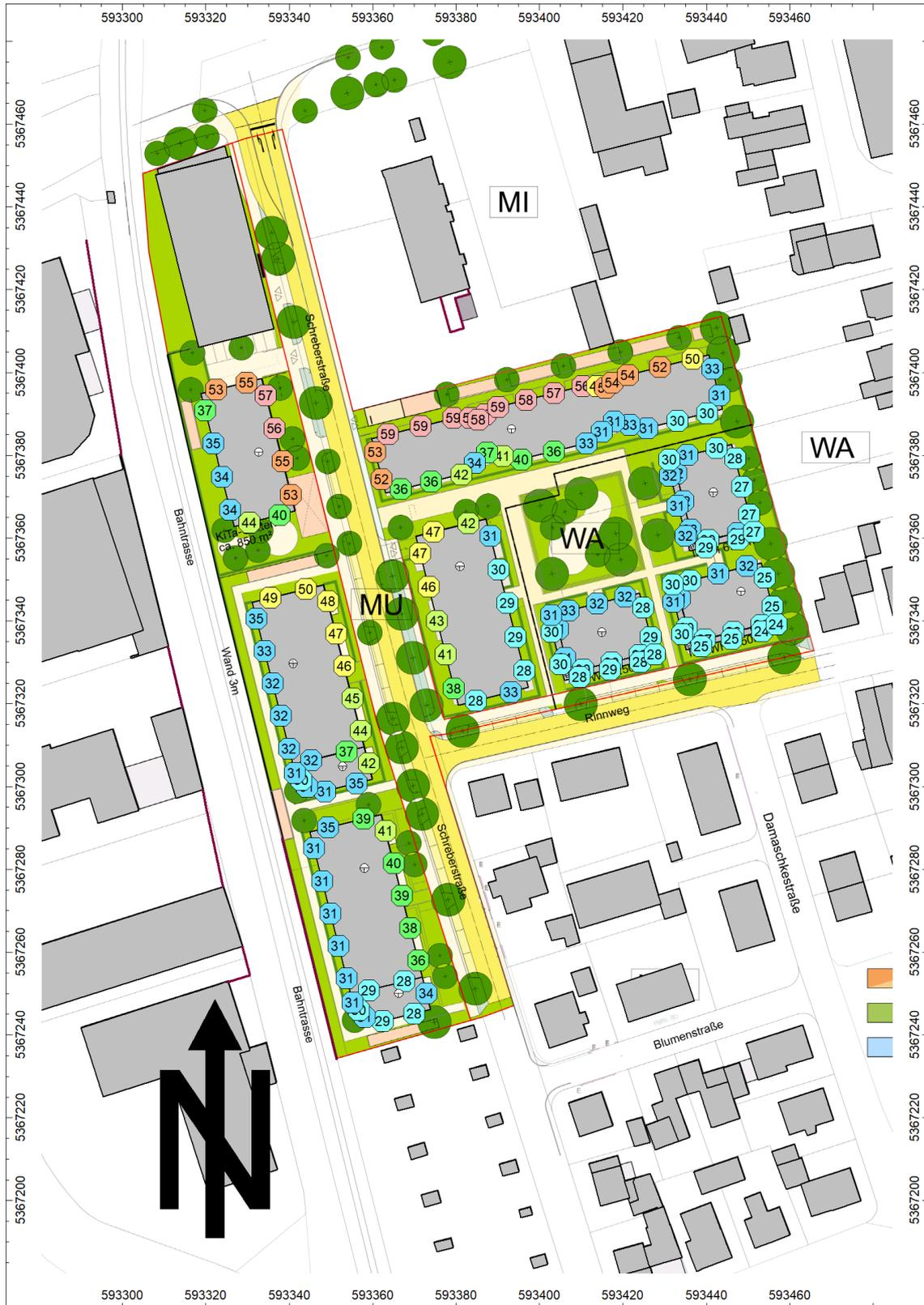
Abbildung 15: Lageplan mit Darstellung der höchsten Beurteilungspegel über alle Geschosse entlang der Fassaden der im Plangebiet vorgesehene Bebauung in der Nacht
